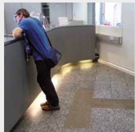
Der taktiler, aber nicht ausreichend optisch kontrastreiche Leitstreifen führt zum Empfangstresen
